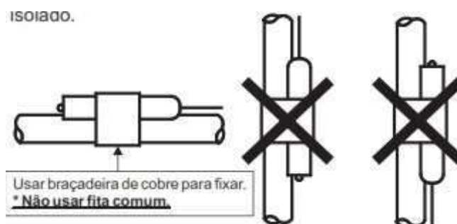
Figura 6 – Instalação do Bulbo
