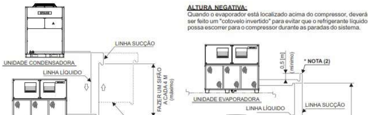
Figura 15 – Uso do sifão nas tubulações
