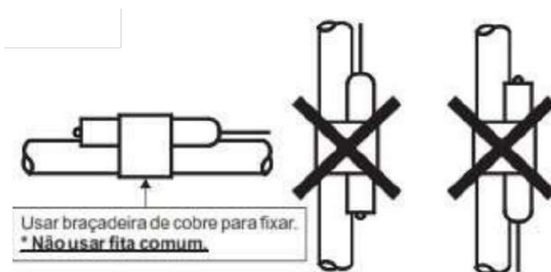
Figura 6 – Instalação do Bulbo
