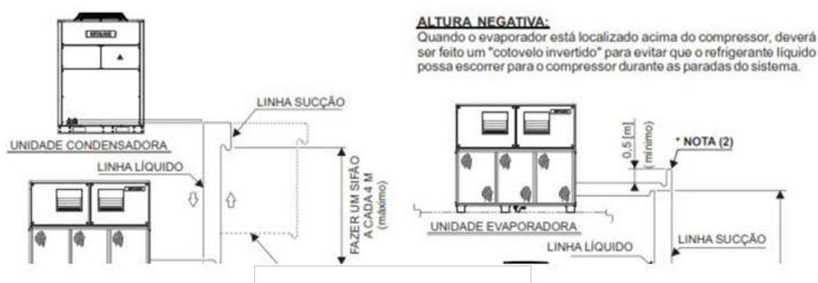
Figura 15 – Uso do sifão nas tubulações
