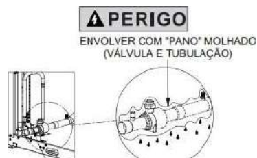
Figura 11 – Cuidados com a preparação da solda
