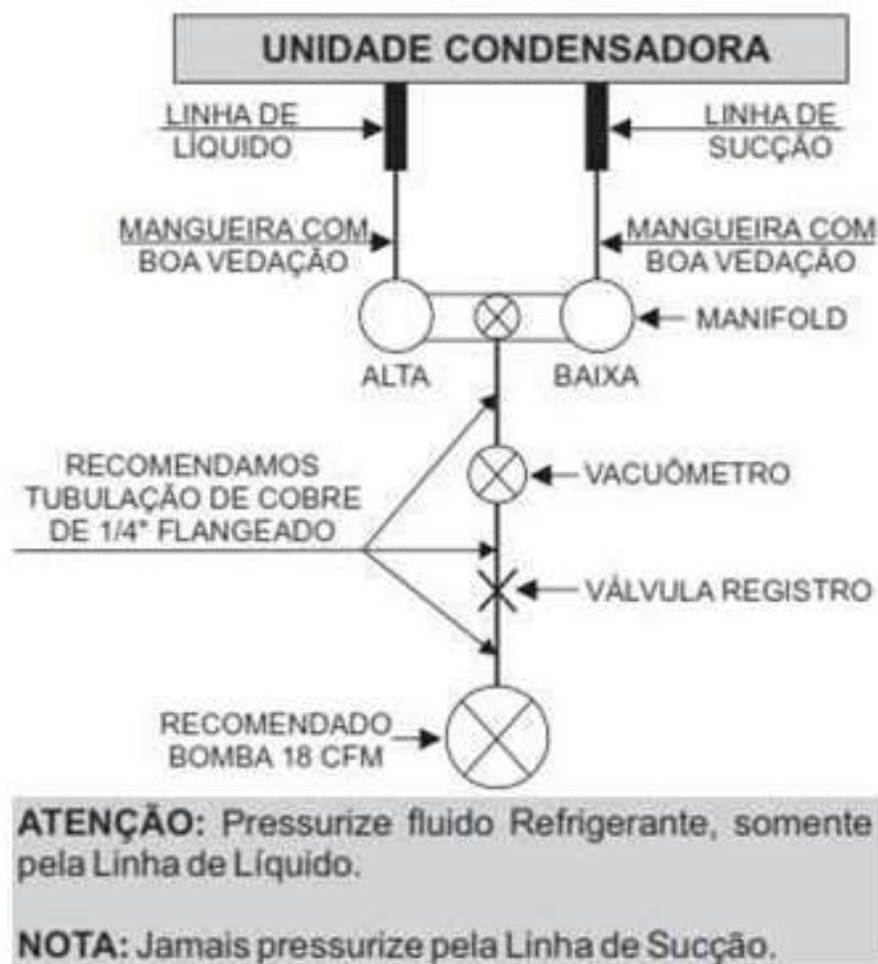
Figura 10 - Vacuômetro na unidade condensadora
