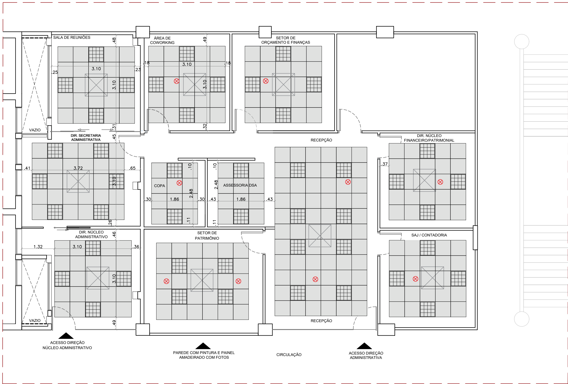
PLANTA DE FORRO (PROPOSTA) - PRIMEIRO PAVIMENTO ESCALA 1:75
