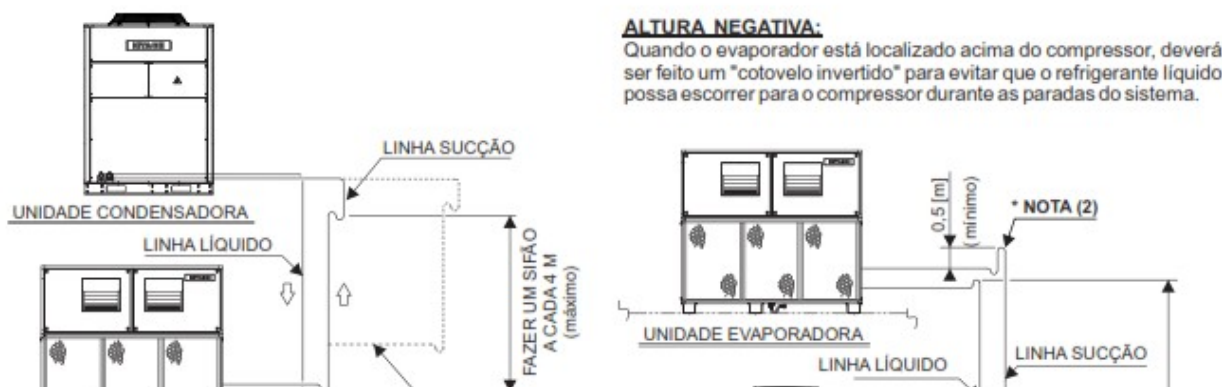
Figura 15 – Uso do sifão nas tubulações
