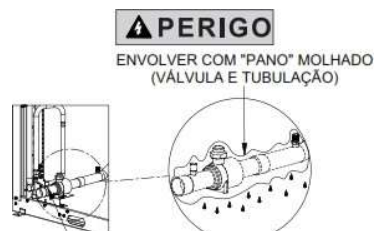
Figura 11 – Cuidados com a preparação da solda
