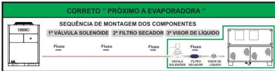
Figura 7 – Instalação da válvula solenóide, filtro secador e visor de líquido
