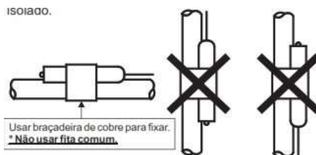
Figura 6 – Instalação do Bulbo
