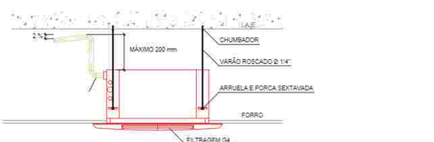
DETALHE TÍPICO COMPONENTES INSTALAÇÃO EVAPORADOR TIPO CASSETE E SISTEMA DE DRENAGEM
